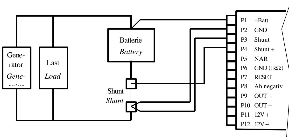
Der Shunt ist zwischen Batterie-Minus und Masse anzuschliessen. Es ist unbedingt darauf zu achten, dass die beiden Anschlüsse P2 und P3 separat zum Shunt geführt werden. Siehe dazu Abb.1
