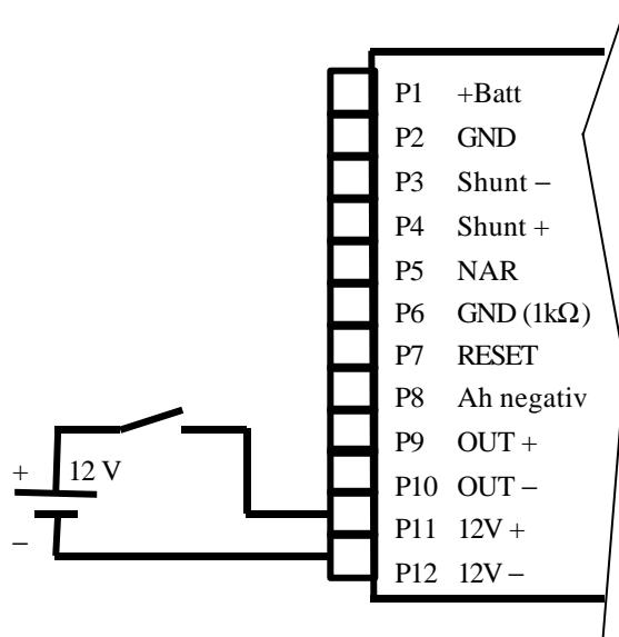
P11 Plus-Pol der Anzeigenbeleuchtung. Diese wird an die 12V Bordnetzversorgung angeschlossen. Sinnvollerweise wird sie zusammen mit der Lichtanlage geschaltet.
